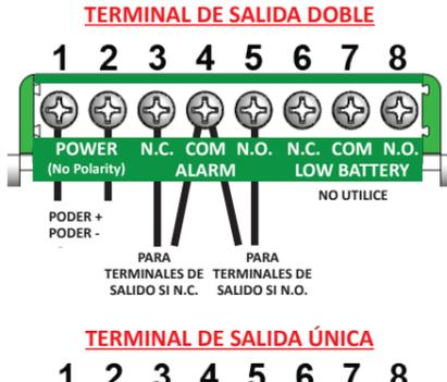
El integrador usa 8-24 VAC o 8-30 VDC. Use seguridad/H.A. sistema u operador de puerta para alimentar o utilizar cualquier fuente de alimentación de 12VDC. Cartell vende fuente de alimentación opcional (Parte #CW-PS).
