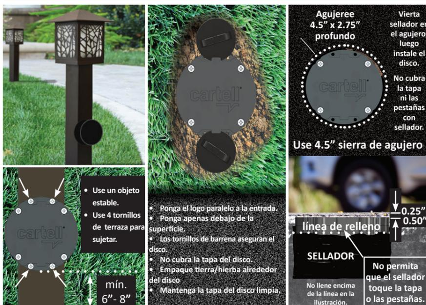
**ADVERTENCIA: COINCIDENCIA EL SENSOR DISCO Y LA TAPA. LIMPIE EL BORDE DEL SENSOR, LA TAPA, Y LA JUNTA DE LA TAPA CON UN PAÑO LIMPIO. COINCIDE CORRECTAMENTE ANTES DE ADJUNTAR.**
